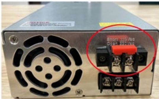
ジャンパーで短絡状態 (AC100V入力の場合)
