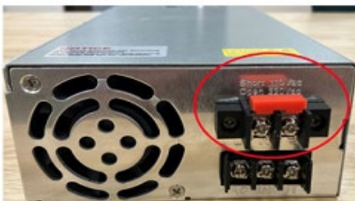
ジャンパーで短絡状態 (AC100V入力の場合)
